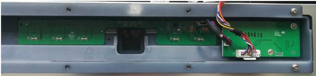
10. TempSensor PCBA wiring
