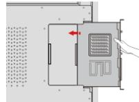
Schritt 3: Den internen PC mit den M3-Schrauben an der Anzeige befestigen.
