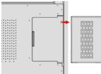
Schritt 2: Den internen PC von rechts nach links in den Anschluss an der Rückseite des Bildschirms schieben
