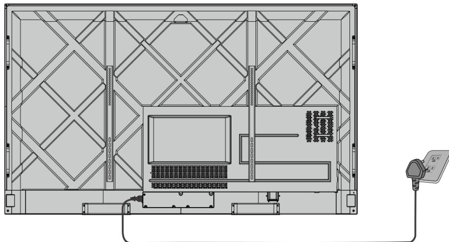
Шаг 2. Включите кулисный переключатель (на задней стороне экрана, рядом с розеткой) после подключения источника питания. Индикатор электропитания должен загореться красным.
