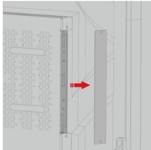
Шаг 2. Вставьте компьютер формата OPS горизонтально в слот для интерфейсных карт.
