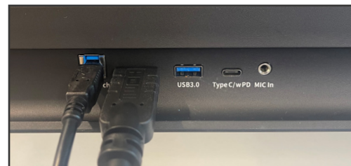
Ports en façade connectés en HDMI et USB-B.
