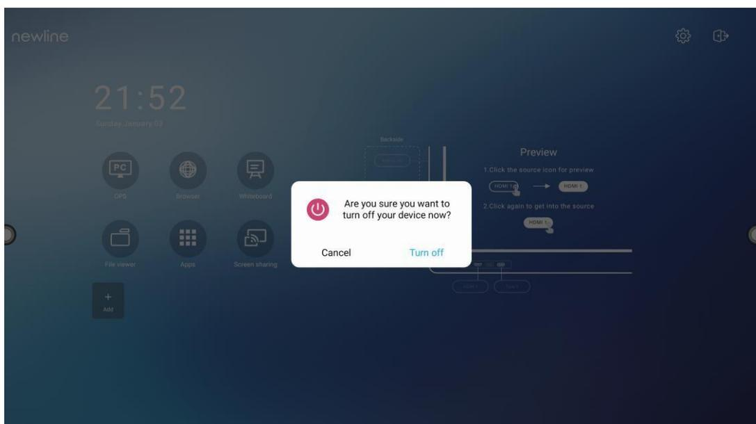
**Paso 3** En la ventana de diálogo de **Advertencia**, seleccione **Cancelar** para volver al modo de funcionamiento. Seleccione **Apagar** para apagar la pantalla; el indicador de la conexión se iluminará en rojo.
